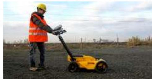
L'appareil émet dans le sol des impulsions électromagnétiques brèves, qui sont réfléchies sur les interfaces entre milieux de constantes diélectriques différentes.
