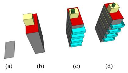
Figure 1. (a)LOD0 (b)LOD1 (c)LOD1 with LOD2 generalization (d) LOD2
