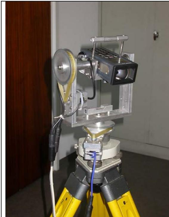
**Abb. 3:** Prototype Laserscanner
