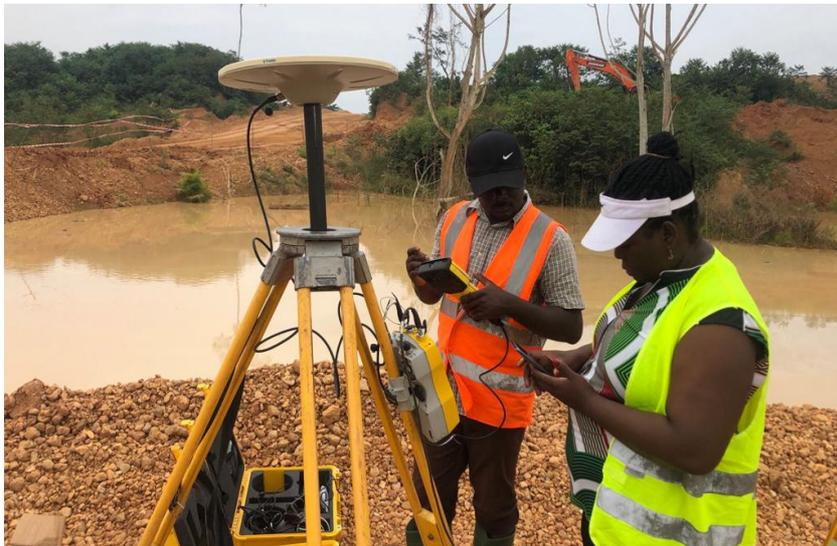
Figure 3: GPS-RTK Survey
