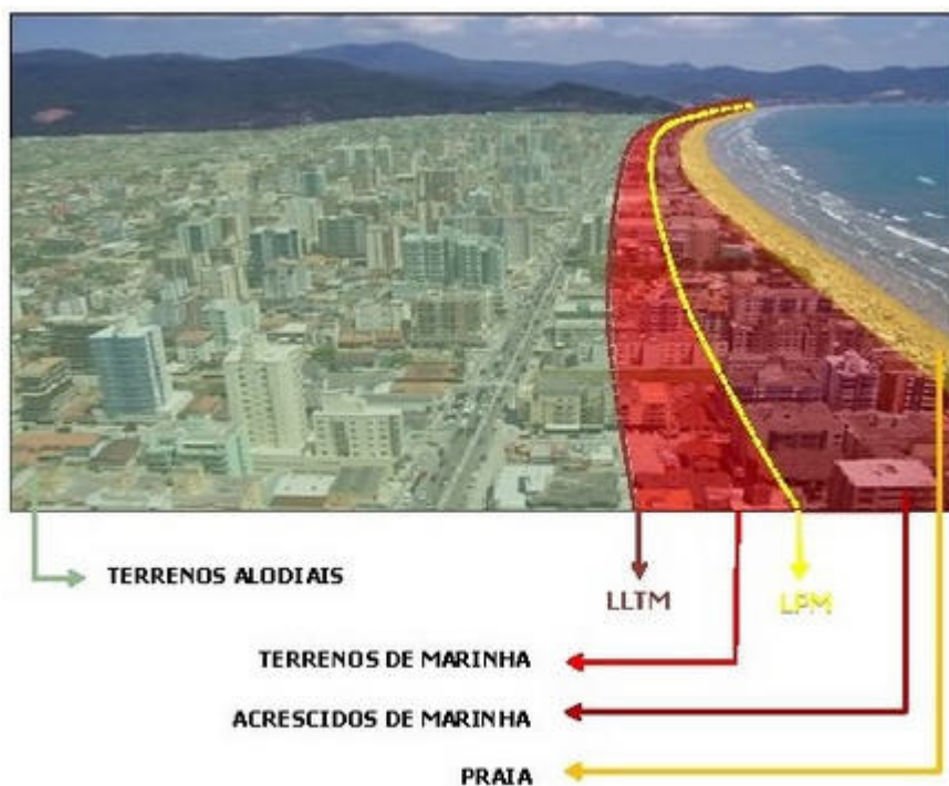
Figura 11. Elementos definidores dos terrenos de marinha.
