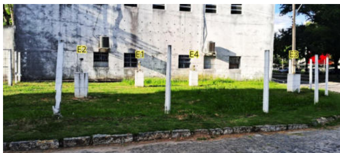
Figura 3. Receptores GNSS instaladas nos pilares
