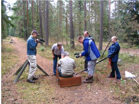
Figure 3. Jussi Kääriäinen and Matti Ollikainen demonstrated invar wire measurements in Nummela. (Photo Pasi Häkli)
